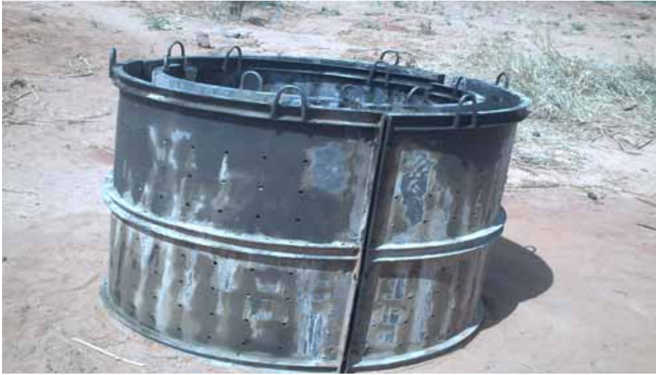
Moule de captage de 1,00 m de hauteur
