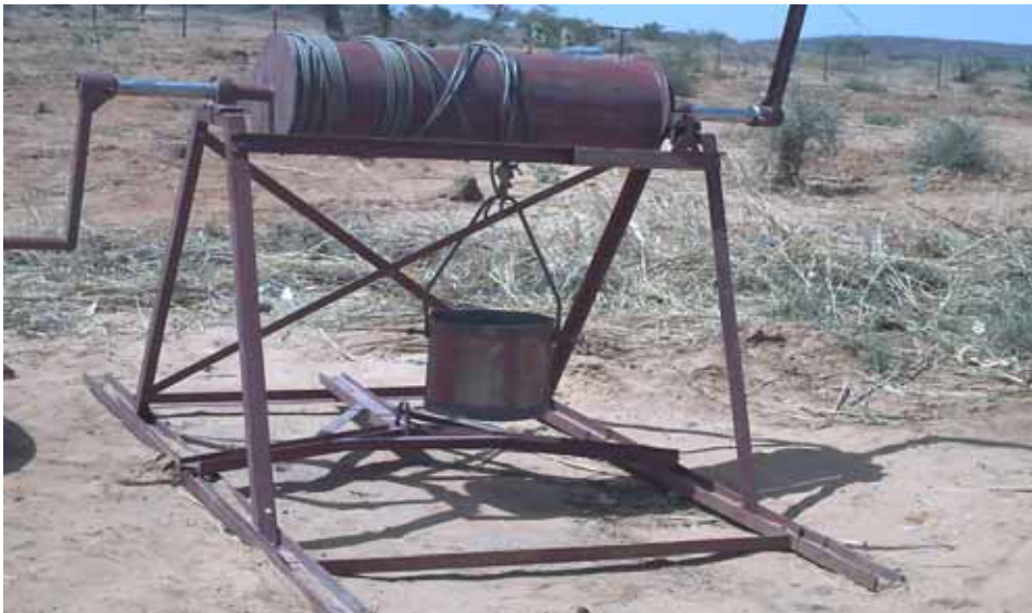
Treuil avec touque de déblais
