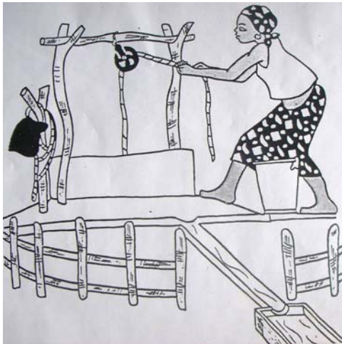
Image N° 8: un puits protégé
