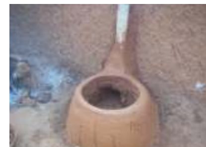
FA Albarka avec cheminée. Constructible dans la case. On peut utiliser un bout de bois pour la confection de la cheminée à retirer à la fin de la construction du FA.
