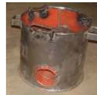
Foyer une cuisine en bois à base des résidus végétaux : glumes de mil, sciure de bois (copo). Foyer à cuisiner à l'aide du charbon minéral, charbon de bois ou des morceaux de bois de petite quantité.
