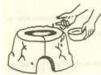
Asperger les côtés des fissures avec de l'eau afin de permettre une bonne adhésion du banco
