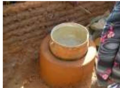
Retirer la couverture. Le foyer s'est rétréci et la marmite ne peut rentrer dans le foyer. Retirer la marmite et aménager les parois avec un couteau tranchant.
