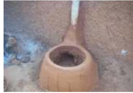
FA Albarka avec cheminée. Constructible dans la case. Coût de la tôle en plus que le FA Albarka. On peut utiliser un bout de bois pour la confection de la cheminée à retirer à la fin de la construction du FA.
